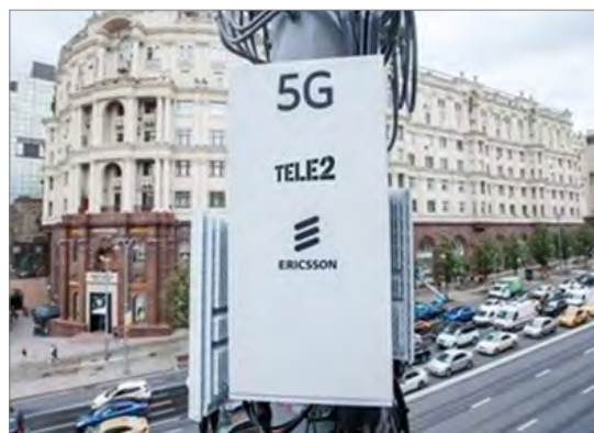
Figure 7: Micro station de base Ericsson 5G dans un environnement urbain (photo: Ericsson)
