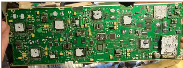
Figure 5: La conception d'un rack BS NOKIA 4G (~ 2014) portant 35 condensateurs au tantale de type D / E (photos: chaîne YouTube Kaizer Power Electronics)
